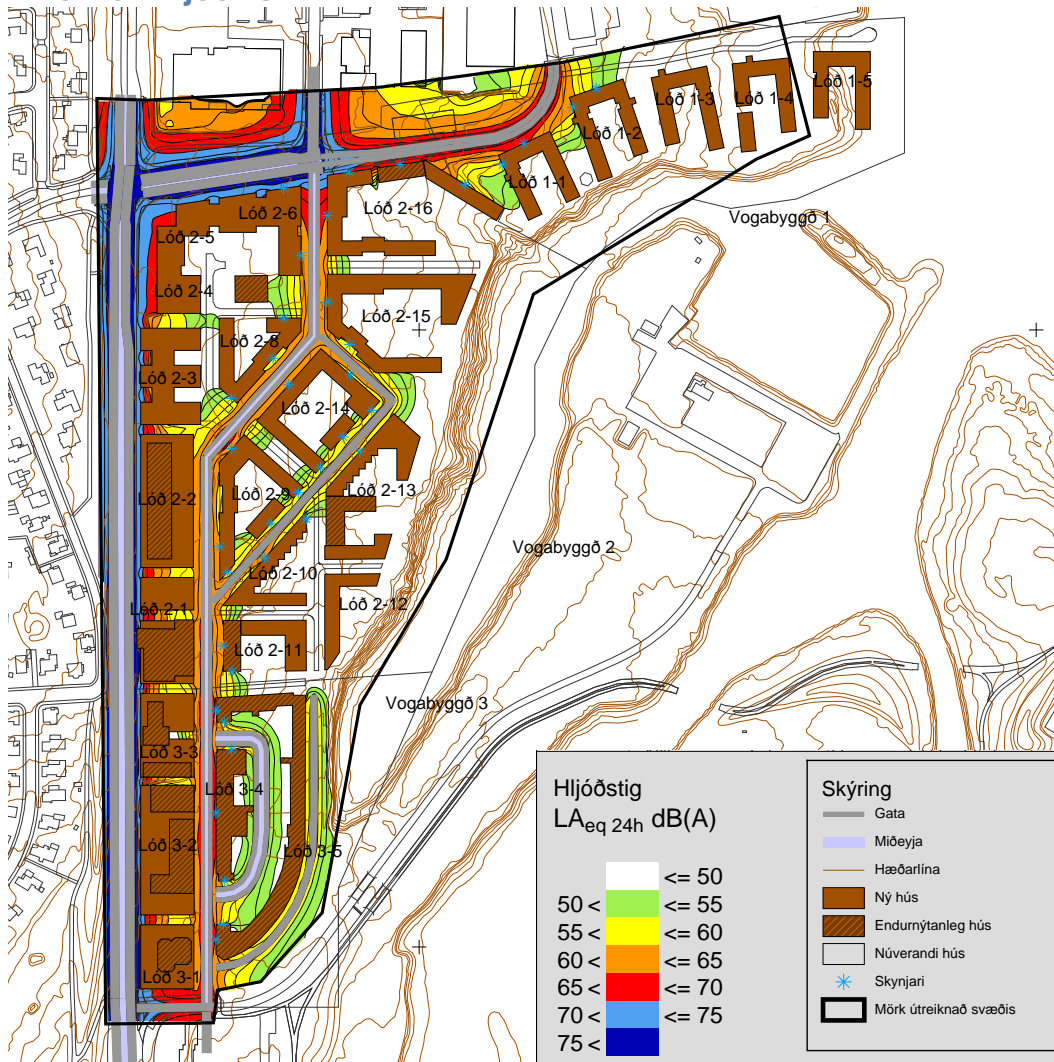
Mynd: Kort 1 Umferð árið 2030 – Dynlínur 2m yfir yfirborði lands. Útbreiðsla umferðarhávaða Breyting á aðalskipulagi Vogabyggðar – Umhverfisskýrsla – Svæði 1, 2 og 3 – Júní 2016 – VSÓ Ráðgjöf.
