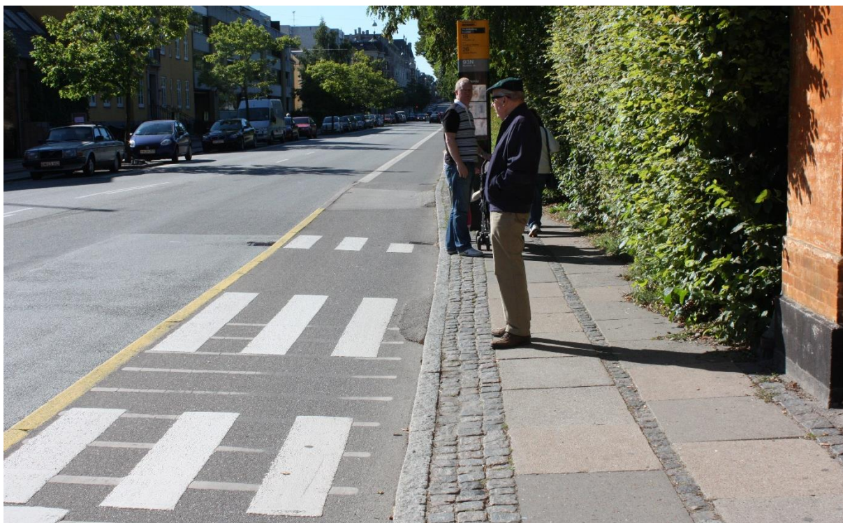
MYND 60 Strætóbiðstöð í Kaupmannahöfn. Strætófarþegar stíga beint út á hjólastíg, hjólreiðamenn víkja.
