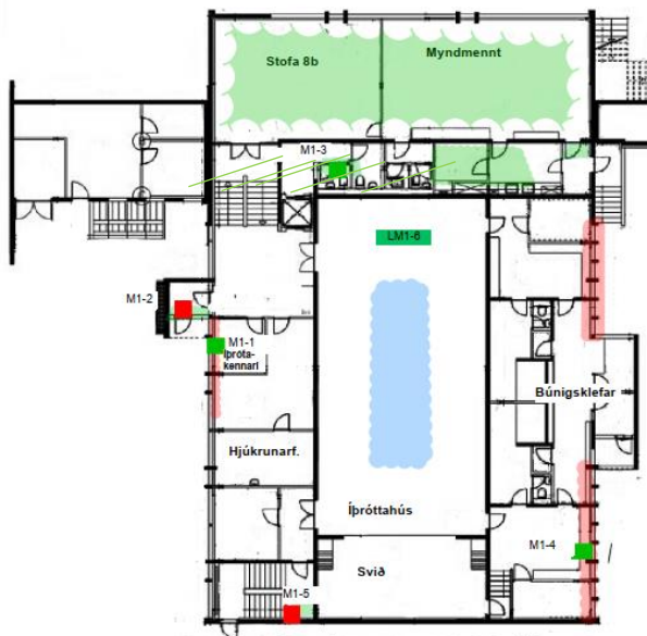
Mynd 16. Yfirlitstekning af fyrstu hæð Meginlands og Austurlands, merkt inn á niðurstöður sýna og rakaummerki
