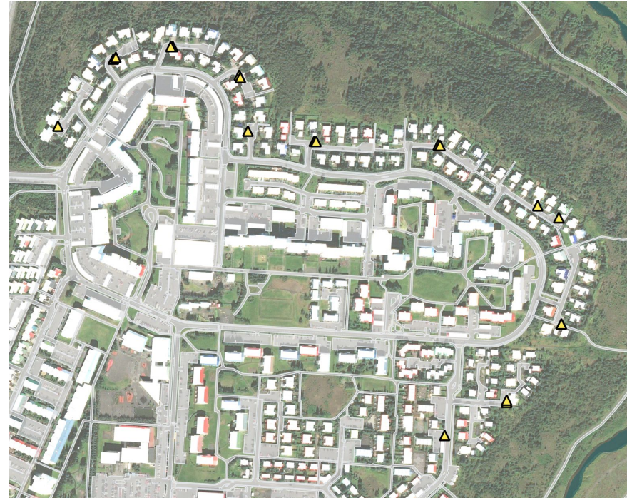
Mynd 2.6: Lágpunktar í Hólum í Breiðholti. Starfsmenn borgarinnar fara á staðinn þegar spáð er mikilli úrkomu og huga að niðurföllum.
