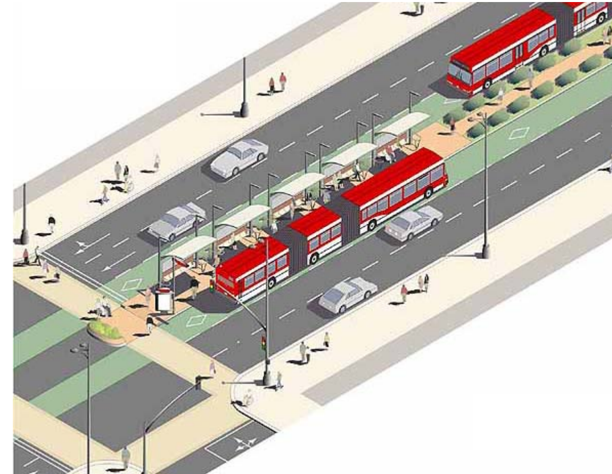
Teikning af forgangsléið strætisvagna (Bus Rapid Transit) í Los Angeles. Forgangsléið milli akbrauta og biðstöð í miðju þjórnar umferð í báðar áttir.
