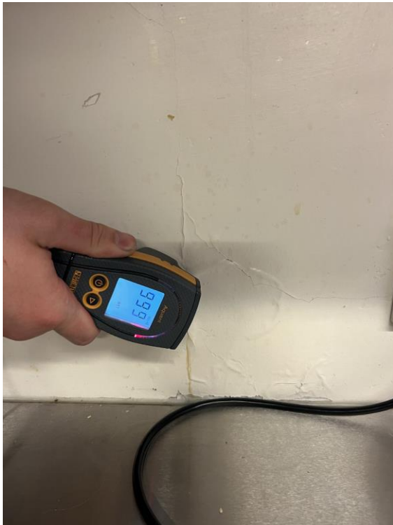
MYND 7 Hækkaður raki við útvegg í sjoppu í norðaustur húsi
