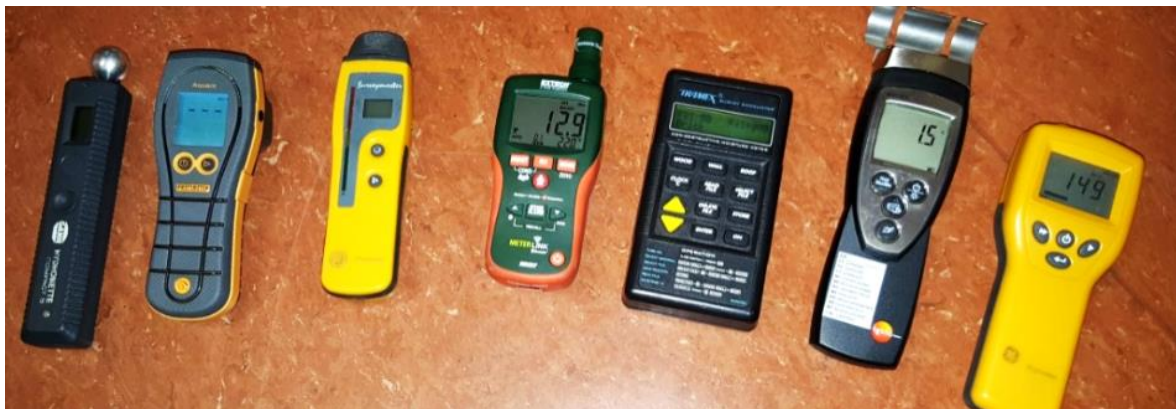
MYND D. : Dæmi um (non invasive) eða snertirakamæla
