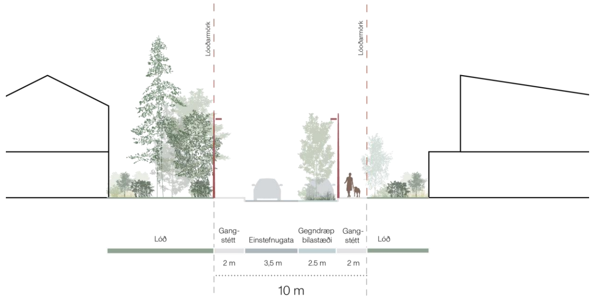
Sniðmynd A. Húsagötur eru einstefnugötur sem tengjast safngötum, þær gegna fjölbreyttu hlutverki. Í húsagötum er m.a. gert ráð fyrir samsíða bilastæðum með gegndræpu yfirborðsefni, í borgarlandi.
