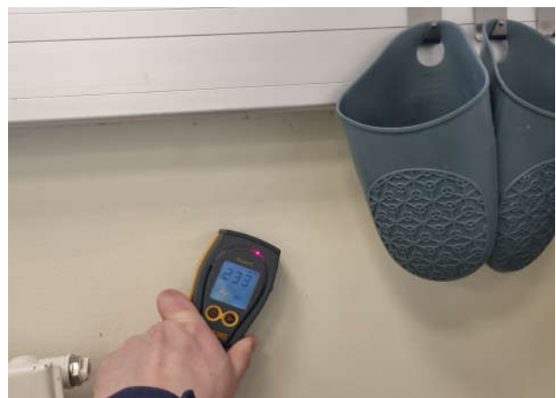
MYND 9 Rakamælingar undir glugga í kjallara. Hlutfallsraki 23,3%.
