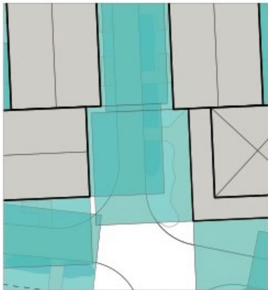
Útveggur t1l útveggjar - 1:1 (fjarlægð/hæð byggingar)
