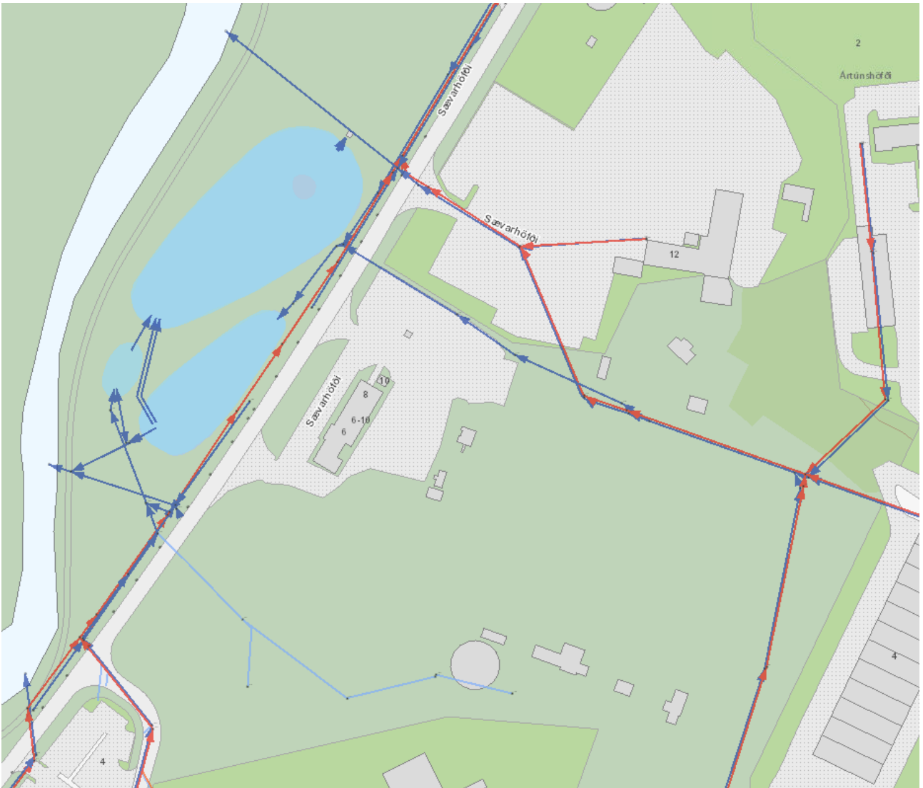
MYND 3 Fráveitukerfi Veitna sem fer nú gegnum Lóð Höfða hf við Sævarhöfða.
