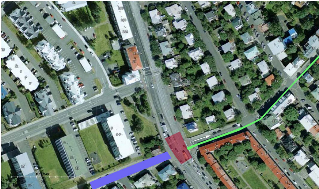
Kaplaskjólsvægur sem vistgata. "Upplyft" gatnamót fyrir gangandi og hjólandi yfir Hringbraut (rautt). Einstefna upp Bræðraborgarstíg og hjólastígur.
